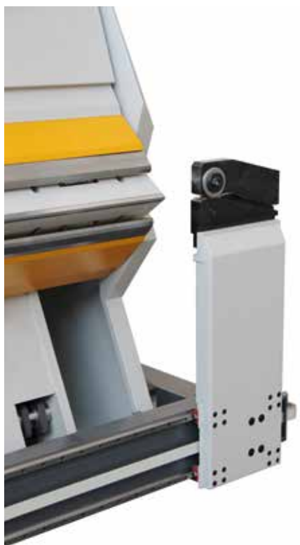
Cut Module pro ořezání širokých polotovarů. Automatická sekvence: řezání a ohýbání.
