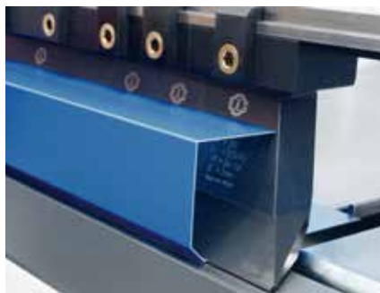
Dělené horní nástroje s dostatkem prostoru v přední části.
