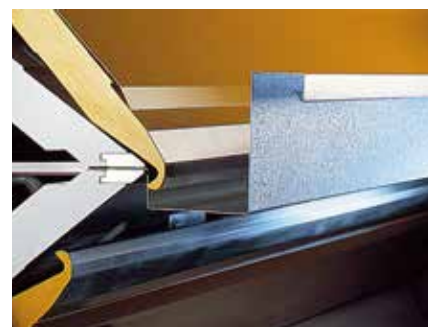
Stroj ohýbá směrem nahoru i dolů, není nutné otáčení dílu. Vysoká produktivita práce díky rychlým ohýbacím cyklům.
