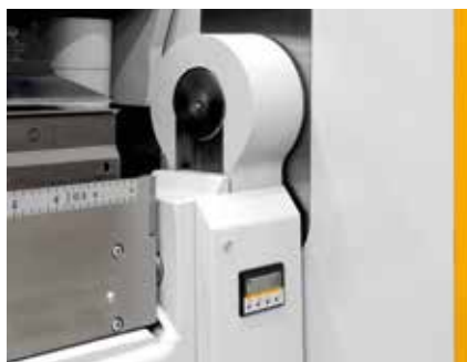
Digitální displej pro nastavení ohýbacího beranu.
