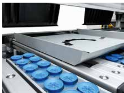
Automatické polohování dílů pomocí přísavkového dorazového systému.
