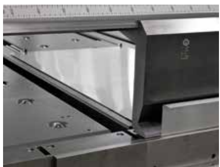
Po dobu ohybu zůstává díl ležet na podpěrném stole. Není nutné díl zvedat.
