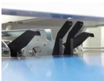
Bezpečné a přesné ohýbání díky automatickému nastavení polotovaru.
