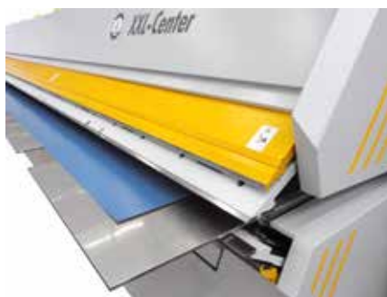
Jednoduché zakládání polotovaru díky odsouvateľným základacím stolům.
