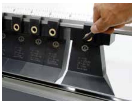
Nástroje s rychloupínacím mechanismem.
