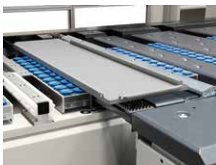
Přesné nastavení dlouhých a úzkých dílů pomocí aktivního pravoúhlého ramene.
