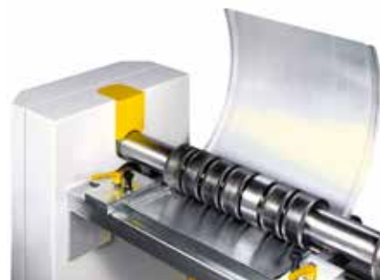
Tvářecí válce jsou lehce nastavitelné na šířku dílu.
