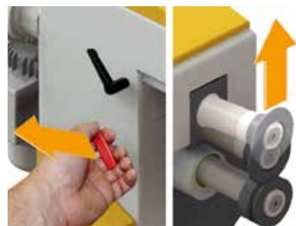
“UnLock” funkce na nouzové otevření koleček.
