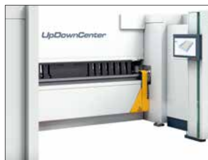
Zařízení bez výměny nástroje. Světelná závora kombinuje bezpečnost a přístup během ohýbání zepředu.
