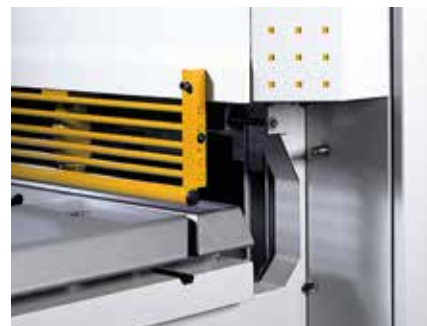
Boční vyložení rámu pro jednoduchou výměnu nožů.
