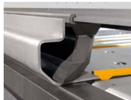
Horní nástroj s dostatkem prostoru v přední části.
