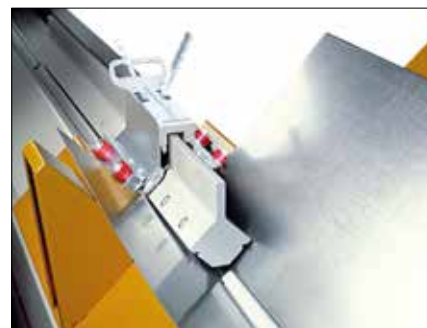
Autopilot a posílený falcovací beran u RAS 20.12 DuctZipper.
