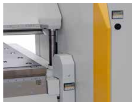
Digitální displej pro nastavení horního ohýbacího a spodního beranu.
