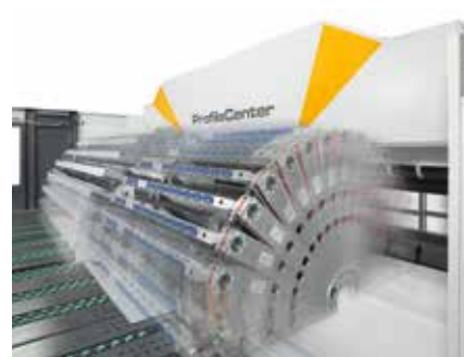
Automatické ohýbání s krátkými časy ohýbacích cyklů hlavně u případů, kdy ohýbaný díl už nemusí být v průběhu ohýbání znovu polohovaný na doraz.
