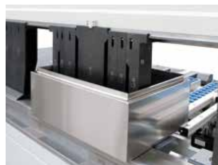
Horní nástroje pro boxy a krabice vysoké až 400 mm.
