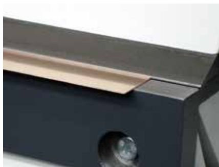
Automatické nastavení ohýbacího beranu na tenké a silné materiály.
