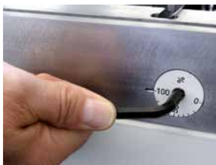
Nastavení bombírování na ohýbacím beranu.
