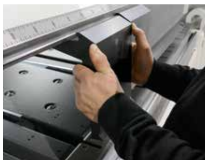
Rychlá výměna a nastavení nástrojů díky automatickému upínání.
