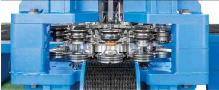
12 Werkzeugplätze, die mit Kassetten zur Aufnahme der Stempel, Abstreifer und schraubbaren Matrizenwischenteller ausgestattet werden.
