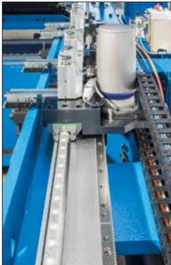
Servoantriebmotor mit Präzisionszahnstangenantrieb.
