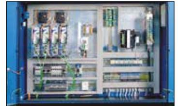
Frei zugängliche Anbringung der elektrischen Komponenten wie Digitalregler, Ventilationskühlung, Trafo und Steuerung
