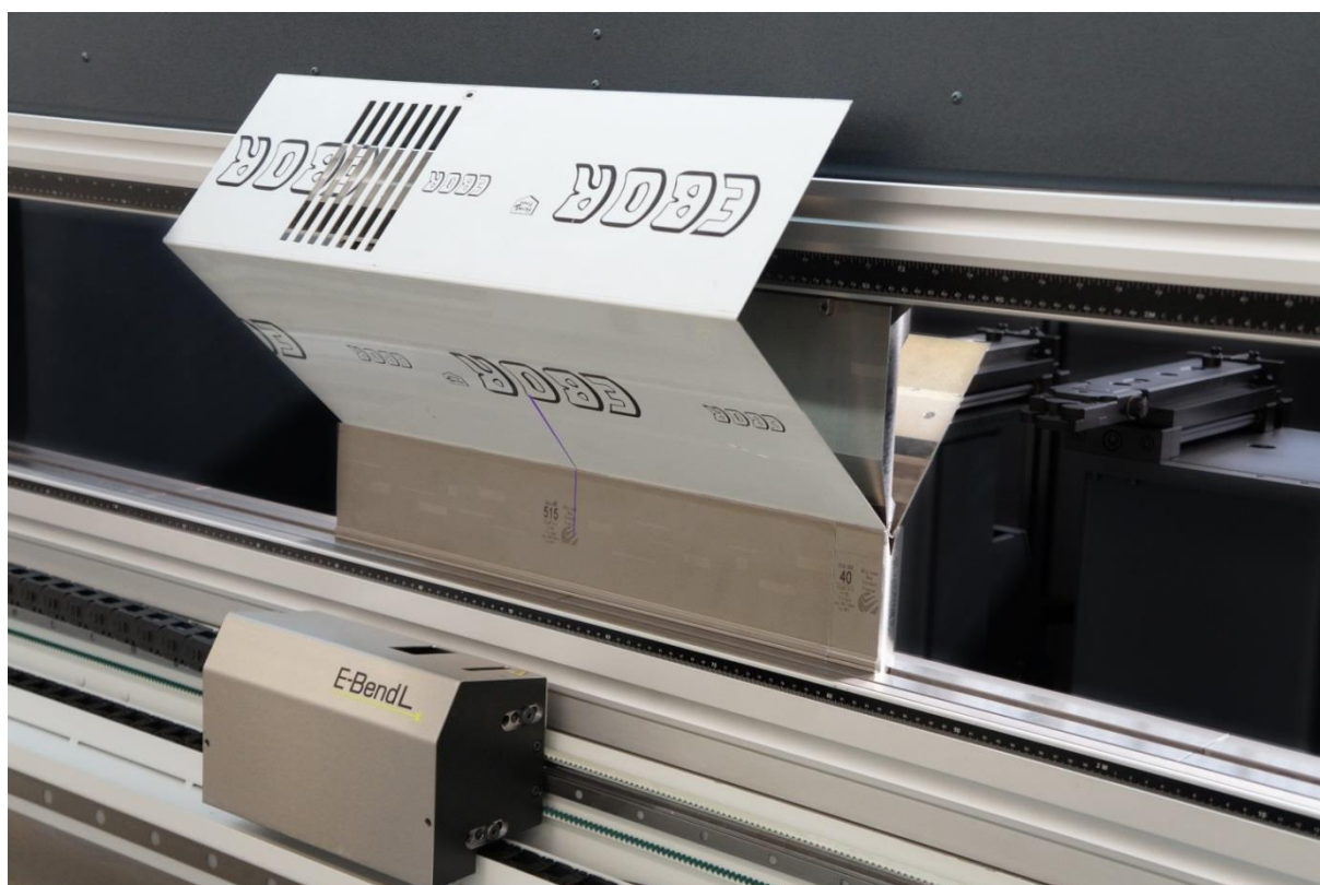
Obr. 1 E-Bend L systém měření úhlu
