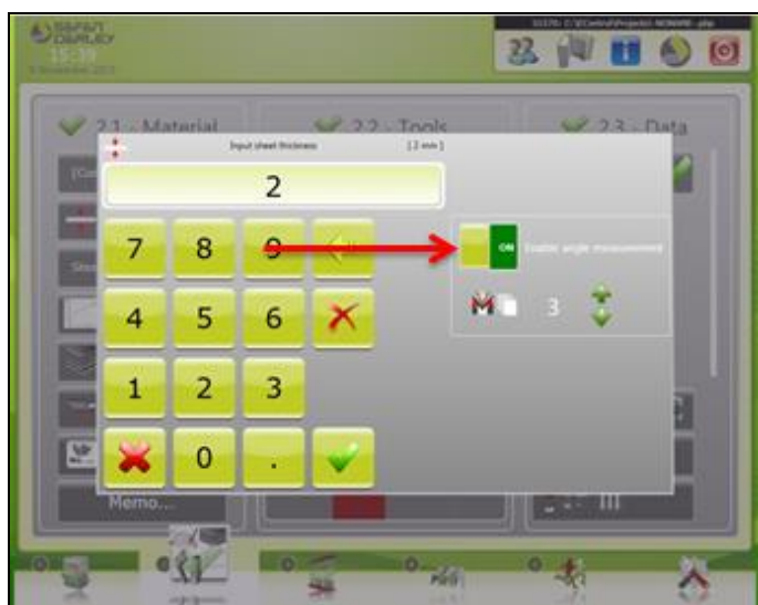
Obr. 2 Aktivace měření úhlu a počítadla
