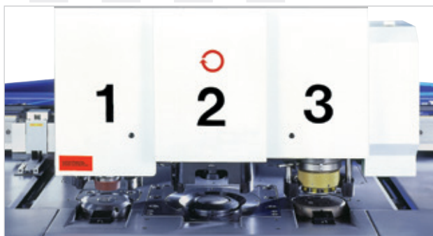
Tri nezávislé vysekávacie hlavy u Boschert TRI. Hlava číslo 3 vybavená združeným nástrojom RevoTool.
