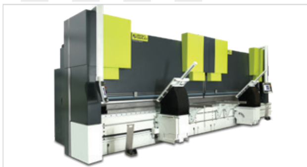
SafanDarley H-Brake Tandem 2 x 6000 kN / 4500 mm s aktivnými podporami E-Mate 2000.
