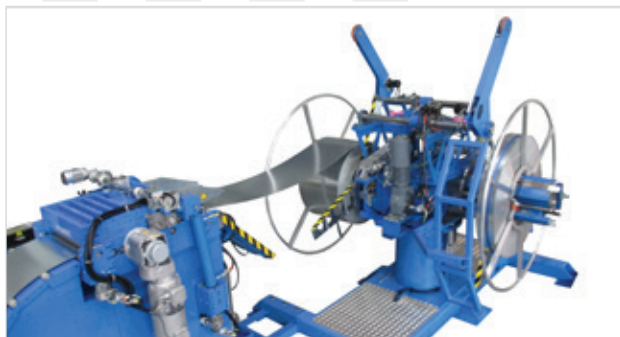
Dvojitý odvíjač umožňuje rýchlu výmenu cievok.
