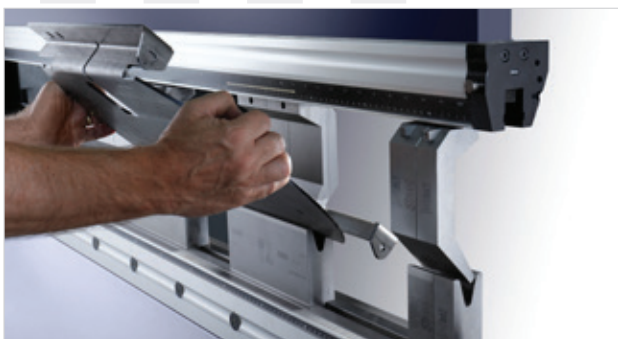
Pracovné stanice vytvorené zo segmentovaných nástrojov. Horné nástroje sú založené z oboch strán.
