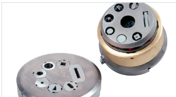
Združený nástroj RevoTool Index 7 s rotáciou všetkých nástrojov a s deliacim razníkom veľkosti 30x5 mm.
