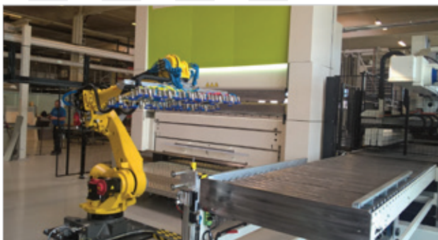
Vstup rozvinov do ohýbacej bunky priamo z vysekávacieho lisu.
