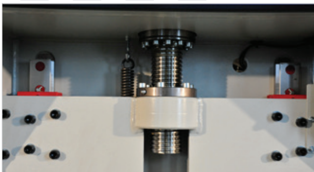
Jednoduchý a spoľahlivý prenos lisovacej sily guľčkovou skrutkou.
