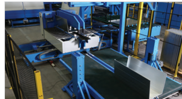
Výroba vysokých opláštení tvaru U na ohýbacej stanici FSO. Možnosť max. výšky bočnej steny do 2000 mm.
