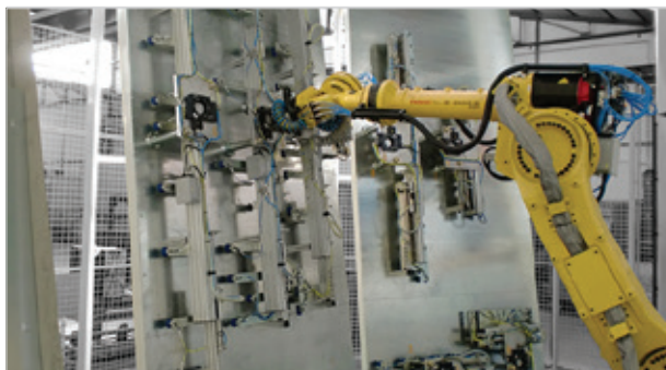
Automatická výmena držiakov výrobkov v ohýbacej bunke.
