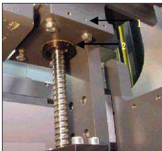
Obrázek 1.1-4 , Jemné nastavování osy R
